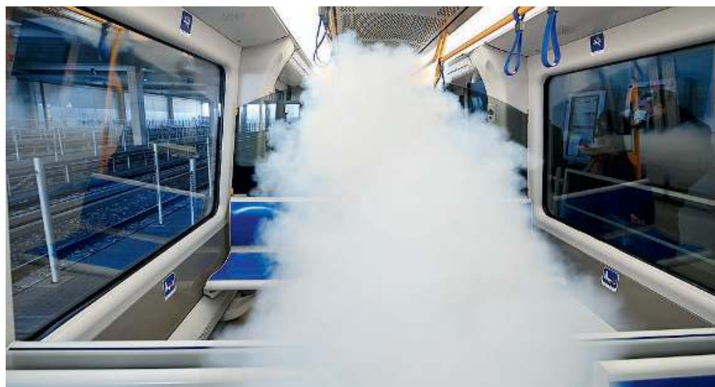
La «nebbia». La «barriera d'argento» viene nebulizzata su un treno della metropolitana
