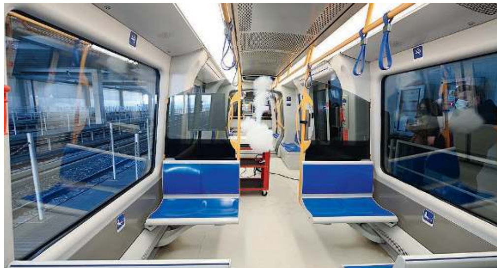
L'erogatore. Posizionato su un carrello, viene azionato tramite telecomando
